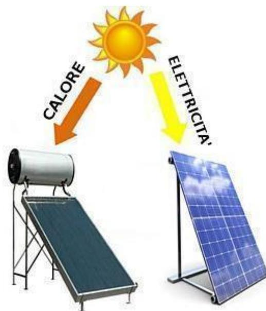
L'impianto solare termico sarà di primaria marca, da posizionare secondo le indicazioni del D.L. a norma di legge con tecnologia a conduzione naturale, con boiler di accumulo di 200 litri, da porre in copertura. Sarà Prevista Predisposizione per Impianto Fotovoltaico.
