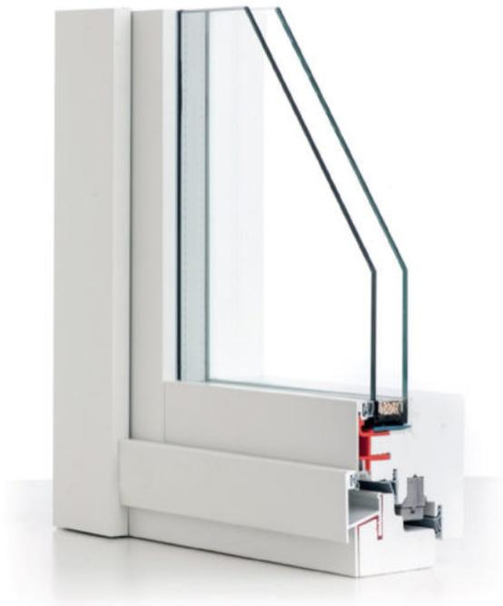
I serramenti esterni sono in legno pino lamellare finger joint 68mm color bianco, con caratteristiche termoisolante e vetro termico basso emissivo, vengono posati su soglie in pietra naturale o artificiale. Presentano ante con apertura a battente; apertura anche a ribalta nei bagni e nelle cucine.
