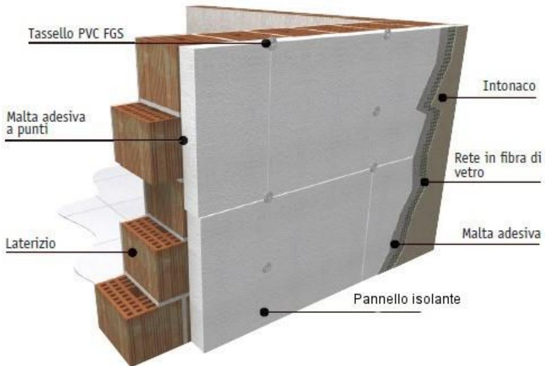
Il sistema costruttivo scelto è del tipo a muratura portante con tamponamento perimetrale in laterizio (poroton – larghezza prevista cm 30); l'isolamento termico verrà garantito da un **cappotto** esterno in pannelli isolanti EPS (**spessore cm 10**).
