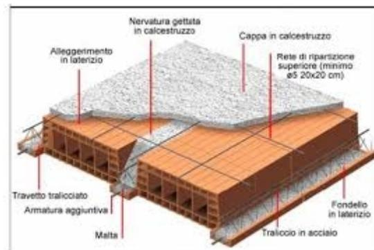
Tutti i solai interpianto saranno in laterocemento con armatura metallica determinata dai calcoli statici, costruiti in opera o con pannelli prefabbricati, atti a sopportare un carico utile di 200 kg/mq oltre carico permanente. In ogni solaio, in corrispondenza dei muri perimetrali, verranno realizzate le coree perimetrali opportunamente armate. In corrispondenza delle canne fumarie sarà ricavato un anello di calcestruzzo opportunamente armato. I solai di copertura saranno in laterocemento.
