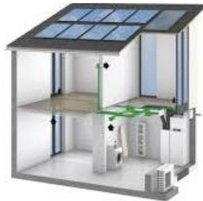
principio di funzionamento, in energia termica (in inverno) od in energia frigorifera (in estate) utilizzabile dall'impianto termotecnico dell'edificio per il riscaldamento ed il raffrescamento dell'alloggio. È alimentata ad energia elettrica, fornita dalla rete o dall'impianto fotovoltaico.
