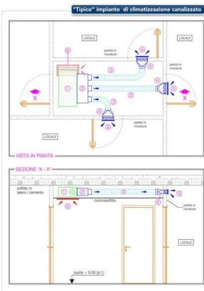
Gli appartamenti sono completi dell'impianto dell'aria condizionata canalizzato in tutte le camere, soggiorno, escluso bagni, cucina e disimpegno, collegato direttamente con la pompa di calore della centrale termica che fornirà le frigorifere per il raffrescamento e il consumo verrà contabilizzato per ogni unità immobiliare
