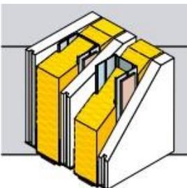
SYSTEM" certificata ETA, costituita da doppia struttura portante in lamiera zincata di sp. 6/10 di mm, di montanti a "C" da 49-74-99 mm di larghezza, posti ad interasse variabile di cm 30-40-60 in funzione delle altezze e guide ad "U" da 50-75-100 mm e all'interno verranno posizionati due materassini in lana minerale che avra' la funzione di isolamento acustico.. Sulla struttura,
