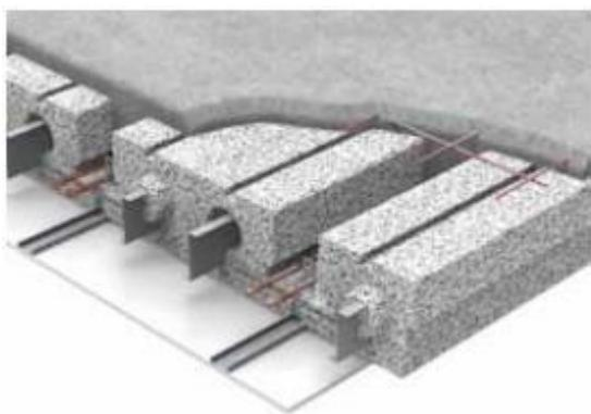
in EPS Cs(10) 100 classe E per ottenere una struttura di solaio a travetti in C.A. come da tavole grafiche. I travetti avranno interasse di 60 cm e il cassero sarà privo di cavità interne all'EPS. Il solaio sarà dotato di supporti metallici preforati, disposti ad interassi di 50x60 cm e inglobati nel calcestruzzo del travetto, per il rapido fissaggio meccanico di qualsiasi tipo di rivestimento all'intradosso anche di tipo REI. I pannelli
