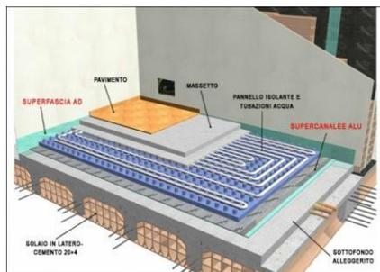
La realizzazione dell'impianto di riscaldamento sarà a pavimento costituito da pannelli radianti e la temperatura ambiente verrà regolata da un termostato direttamente posizionato all'interno dell'appartamento.
