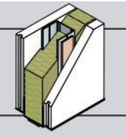
ETA, costituita da una struttura portante in lamiera zincata di sp. 6/10 di mm, di montanti a "C" da 49-74-99 mm di larghezza, posti ad interasse variabile di cm 30-40-60 in funzione delle altezze e guide ad "U" da 50-75-100 mm e all'interno verra' posizionato un materassino in lana minerale che avra' la funzione di isolamento acustico. Sulla struttura, verranno avvitate (una per
