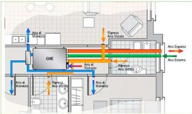
bocchette di mandata e ripresa dell'aria nei vari locali. Il sistema di ventilazione meccanica permette di mantenere alti i livelli qualitativi dell'aria interna, assicurando meccanicamente il corretto equilibrio fra l'aria fresca e salubre in ingresso dall'esterno e l'aria viziata che verrà espulsa dall'abitazione. Contemporaneamente il
