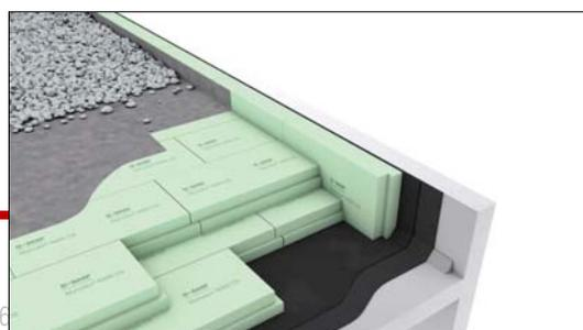
La coibentazione sarà in EPS dello spessore minimo di 14 cm come da progetto e comunque nello spessore minimo previsto dalla L.P. 1/2008 e successive varianti;
