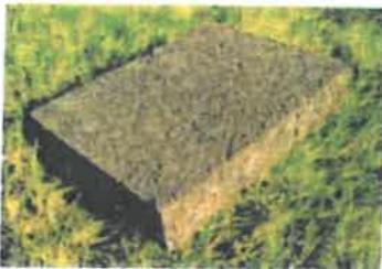
*Isolamento termico delle murature esterne, escluse quelle in mattoni faccia vista, a "cappotto" realizzato mediante l'impiego di pannelli rigidi di sughero vergine ecologico certificato o prodotto equivalente certificato bio, ancorati sulla faccia esterna delle pareti perimetrali verticali ed orizzontali.*
