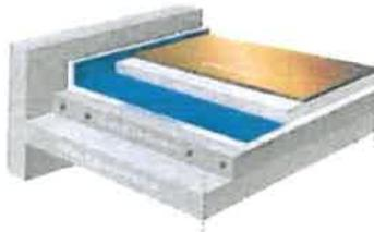
*A livello orizzontale di ogni piano abitativo, verrà realizzato un massetto leggero in cemento espanso, con funzione di copertura e livellamento degli impianti sottotraccia, dello spessore risultante dal calcolo e quale supporto al sistema di riscaldamento a pavimento. L'estradosso del solaio del piano terra sarà opportunamente coibentato.*
